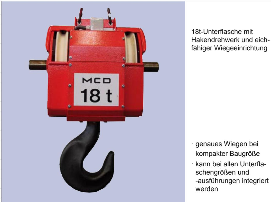
Diese Unterflasche ist für den Betrieb an einem Halbautomatik-Kran konzipiert. Während des Wiegevorganges hängt die Unterflasche mit Last frei, so dass keine Verfälschung des Messergebnisses erfolgen kann, solange sie in keiner Richtung mehr als 2° aus der Lotrechten schief hängt. In diesem Falle würden innerhalb der Messdosenaufhängungen mechanische Kontakte stattfinden, die eine eichgenaue Wägung unmöglich machen würden.
